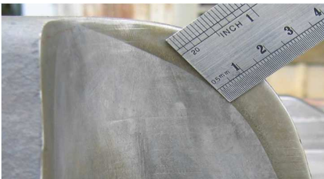
Driving lug case depth 13 mm
