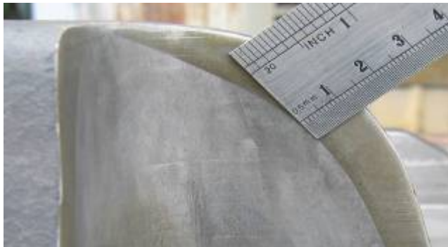
Driving lug case depth 13 mm
